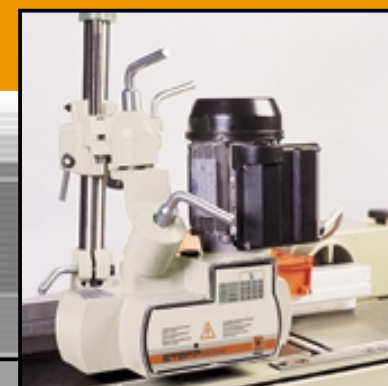
▲ Posizionamento su pialla a filo
